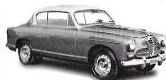
**1954** La 1900 C Sprint de 2<sup>e</sup> série est équipée de pare-chocs plus gros et à butoirs. La berline 1900 est remplacée par la 1900 Super à moteur réalésé de 1 975 cm<sup>3</sup> (90 ch et 160 km/h sur 1900 Super et 115 ch et 180 km/h sur TI Super à 2 carburateurs). Présentation du coupé 1900 C Super Sprint (moteur de TI Super, boîte 5 vitesses à commande au volant, 190 km/h) à carrosserie légèrement retouchée (surface vitrée augmentée, nouvelles moustaches de calandre...).
